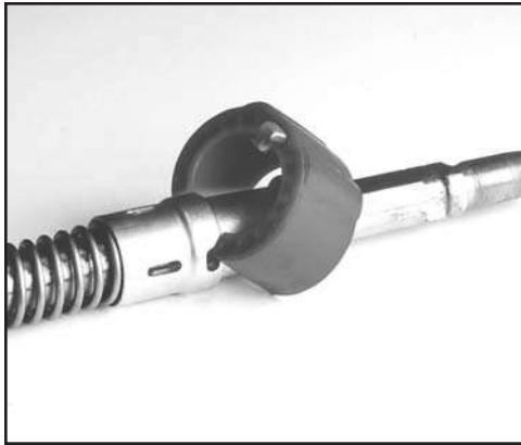
FIG. 41: REMOVE EXHAUST RING
