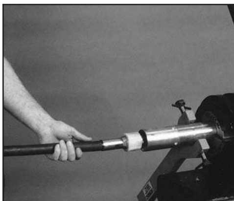
FIG. 52: INSERT CONTROL STUD
