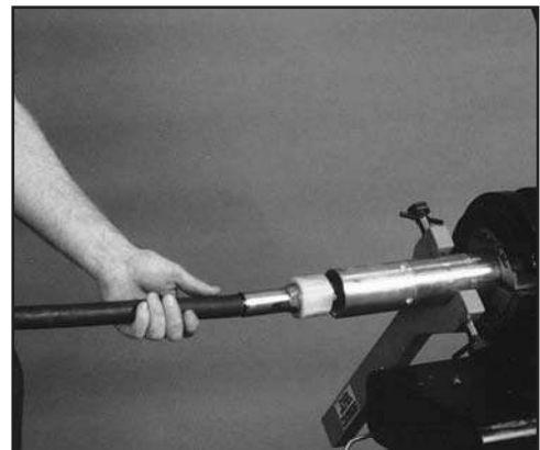
FIG. 40: REMOVE CONTROL STUD
