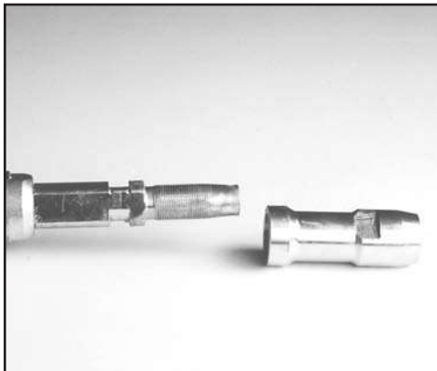
FIG. 43: REMOVE CONTROL STUD ADAPTER
